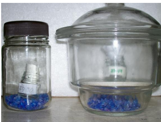
Figura 2. Frascos de vidrio con frutos inmaduros acondicionados y colocados dentro del desecador de vidrio alternativo y desecador de vidrio original.
